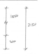
BONDED STONE FACE CLADAUNG = 22 KN/m3
